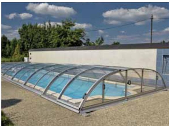
La struttura a forma di arco "basso" è costituita da profili con finitura superficiale Elox e copertura in policarbonato alveolare 8 mm con protezione UV. La copertura scorre su un profilo a binario con rotaie. La parete frontale è removibile. Vi sono 2 accessi: una porta è sulla parete frontale, una laterale che è posizionabile sul lato destro o sinistro della copertura.
