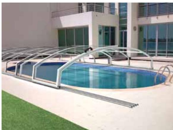
Khalid è costituita da una struttura in moduli in lega di alluminio con trattamento superficiale con effetto CARBON. La copertura scorre su due binari con rotaie per coprire parzialmente o totalmente la piscina. Vi sono 2 accessi: una porta è sulla parete frontale, una laterale posizionabile sul lato destro o sinistro della copertura.
