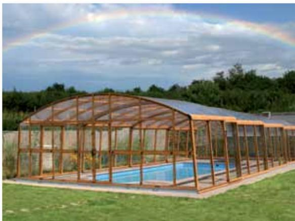
Chrysler è costituita da una struttura in moduli in lega di alluminio con trattamento superficiale con effetto legno. La copertura scorre su due binari con rotaie per coprire parzialmente o totalmente la piscina. La parete anteriore è fissa e divisa da aletta di battuta con una porta a due ante.
