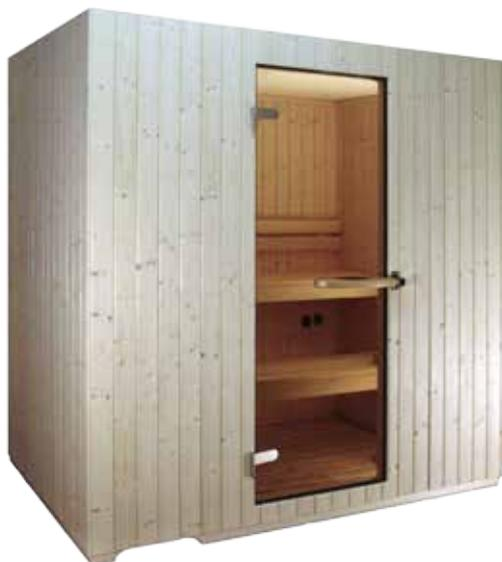
Struttura in pannelli perlinati con intercapedine isolante in lana di roccia e foglio di alluminio, spessore telaio c.a. 7,2x4,6 cm, ricoperto su entrambi i lati da perline. Ampia porta di cristallo bronzato e temperato 8 mm di spessore con guarnizione a tenuta.
